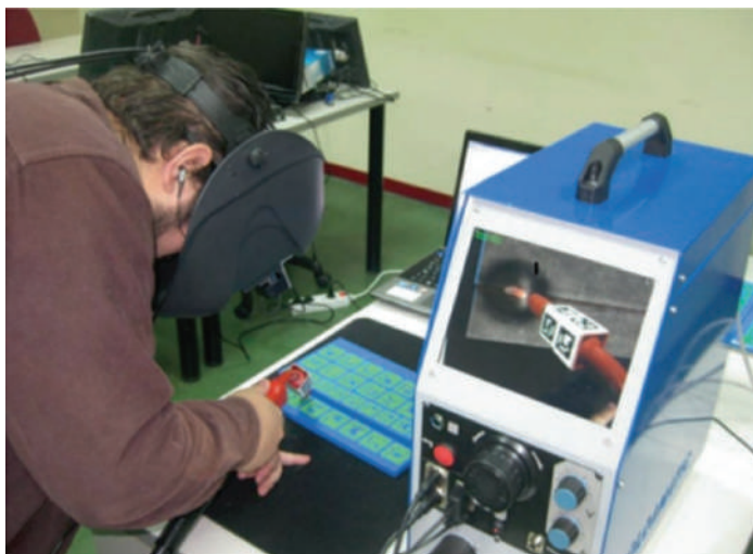
Слика 24. Заваривачка обука у окружењу проширене стварности
