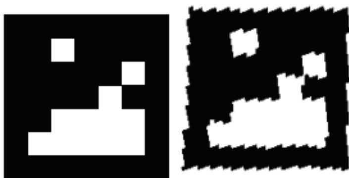
Слика 14б. Изглед маркера у Рекимотовом систему (Лијево оригинални, десно очитан путем камере)
