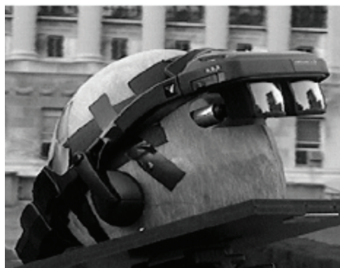
Слика 7. Изглед визира са камером и слушалицама и слушалицама MARS
