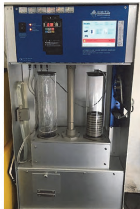
Сл. 5. Гравиметријски узоркивач укупних чврстих честица и PM 10 Fig. 5. Gravimetric sampler of total solid substances and PM 10
